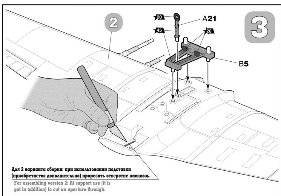
Для 2 варианта сборки: при использовании подставки (приобретается дополнительно) прорезать отверстие насквозь.
