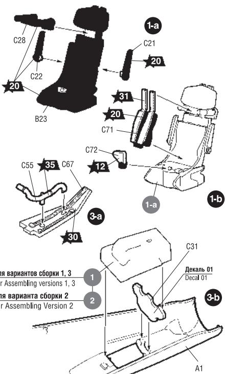
Приклеить деталь на указанное место / To glue a detail on the specified place
